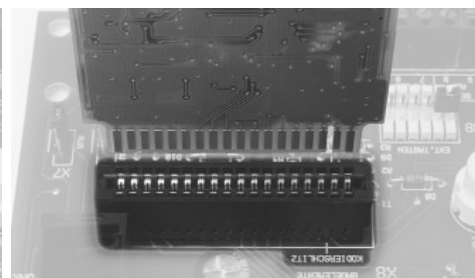
Włożyć TS4-2 do listwy wtykowej X8 (rowek kodowy zgodnie z oznaczeniem na płytce).
