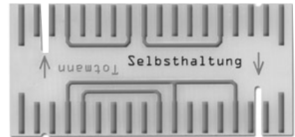
Codificação para automanutenção
