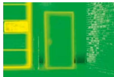
Deutlich geringerer Energieverlust dank thermisch getrennter Tür
