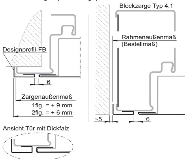
Montage für **Feuerschutz:** • T30-1/2-FSA „Teckentrup 62“ Dünnfalz
